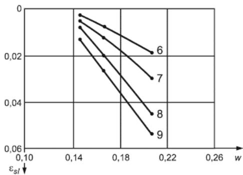
в) График зависимости относительной просадочности от влажности
