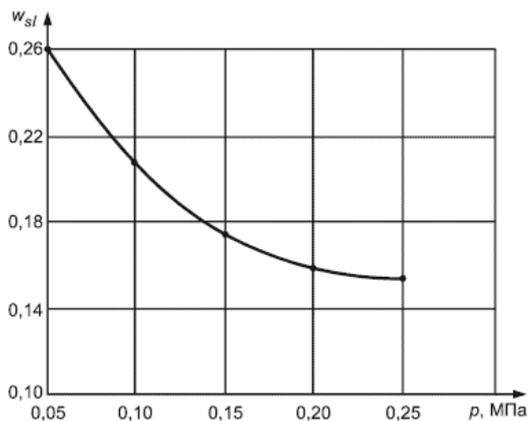
б) График зависимости начальной просадочной влажности  $w_{sl}$  от давления  $p$
